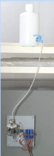
制御センサーユニット 取付板に付属品 組付状態
